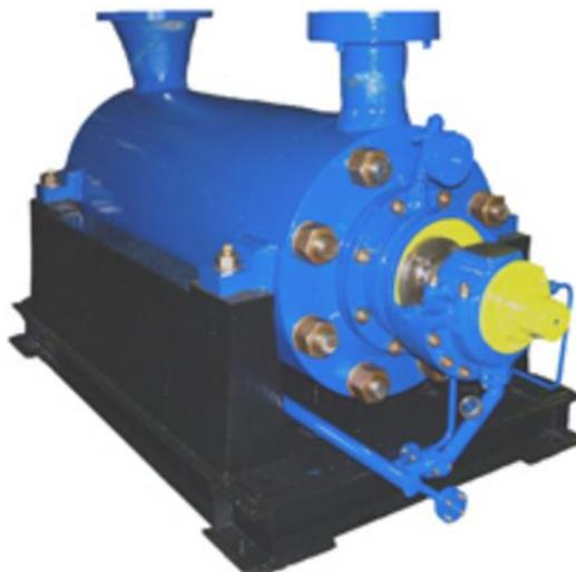
Насос **ЦНС 630-1700** предназначен для закачки в нефтеносные пласты после механической очистки речной и подтоварной неагрессивной воды. Насос **ЦНС 630-1700** - центробежный горизонтальный секционный 8-ступенчатый однокорпусный с односторонним расположением рабочих колес. Концевые уплотнения - торцовые. Опорами ротора являются подшипники скольжения с принудительной смазкой. ротор разгружен от осевой силы гидравлической пятой.
